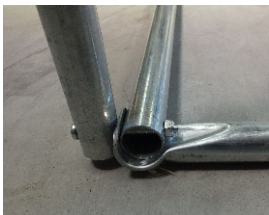
Spoj čelní rohový
